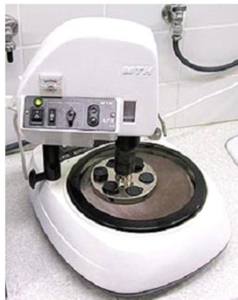
Obr.5: Univerzální brusící a leštící stroj MTH Standard 30 - zpracuje až 6 vzorků současně
