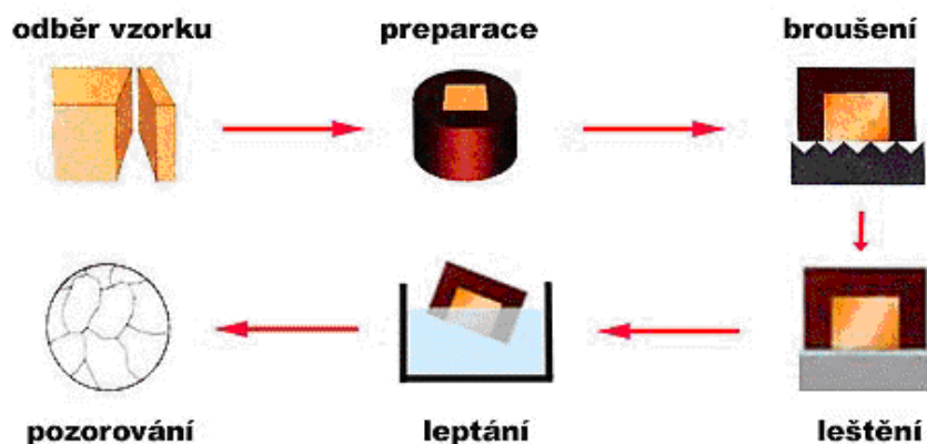
Obr.1: Schéma přípravy metalografického výbrusu
