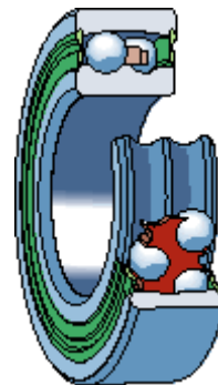
utěsněné naklápěcí kuličkové ložisko
