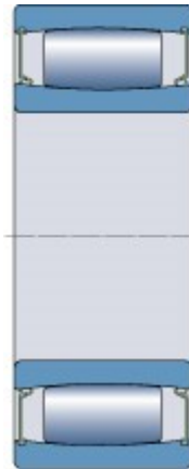
toroidní ložisko s těsněním
