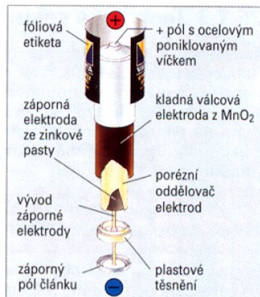
Obr. 1 Alkalicko-manganový článek
