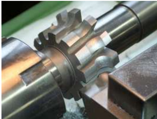
Obr. 2. Podsoustružování hřbetů tvarové frézy
