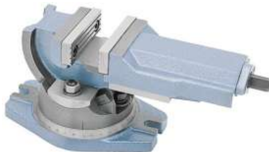
Obr. 5. Strojní svěrák otočný a sklopný
