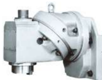
Obr. 6a. Prostorová frézovací hlava
