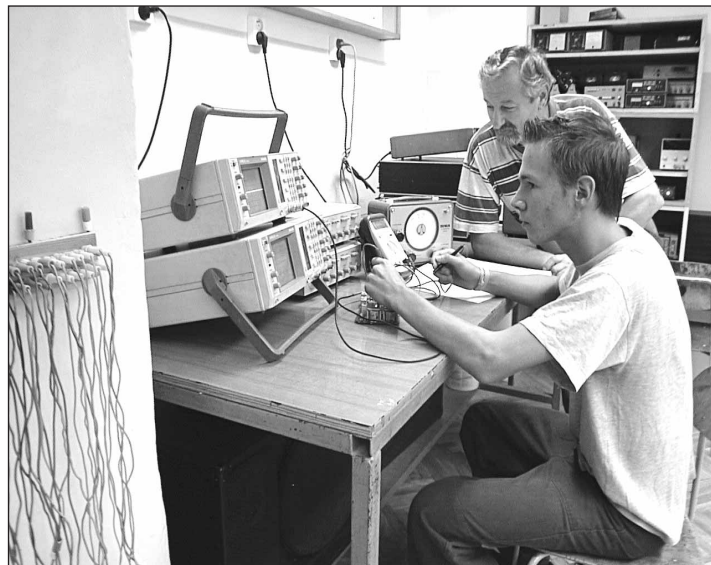
Učitel odborného výcviku pan Miroslav Řehula kontroluje správný technologický postup žáka učebního oboru elektrikář při měření osciloskopem u nízkofrekvenčního zesilovače.
